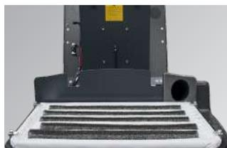
Filtro a tasche in poliestere con scuotifiltro elettrico di serie. Controllo delle polveri tramite il sistema di filtraggio
